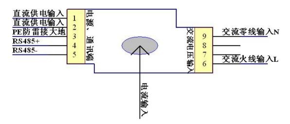
注:接线图中第 1、2 接线端为直流电源输入接线端,直流电压不分方向,直流电压 供电范围 12V~30VDC。
